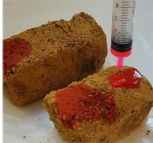
Fig 4. Muestra de todas las probetas tras la aplicación de los consolidantes.
